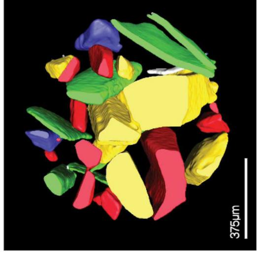
단일 에너지 스캔에서는 알루미늄과 실리콘의 거의 동일하게(좌) 유태한 화석조 대비를 보입니다. ZEISS Xradia 620 Versa에서만 이용할 수 있는 DS Cover로 입지를 분리할 수 있습니다. 알루미늄/녹색, 규산염/적색을 보여주는 3D 렌더링(우).
