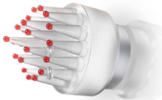
XRM Check: ZEISS는 소규모 치수의 CT 측정 정확도를 검증하기 위해 (다중 구) 길이 표준을 개발했습니다. 이 표준은 VDI/VDE 2630-1.3 기어드라인에 따라 편차 SD를 결정하는 데 사용됩니다.
